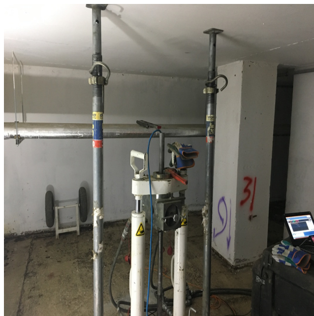
Рис.1. а и б - Переносная установка статического зондирования.
