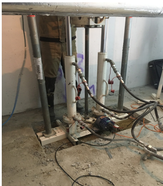
Рис.1. а и б - Переносная установка статического зондирования.
